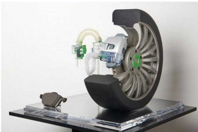
Le TAMIC® est un système de récupération des particules fines émises lors du freinage des autobus.
